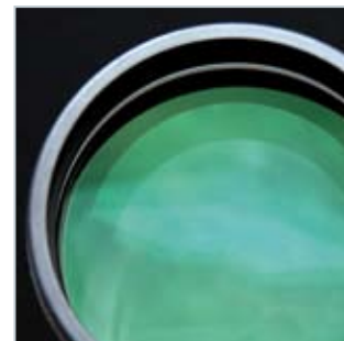
Erscheint das Objektiv weitestgehend in einem homogenen Farbton (hier z. B. grün), kann man von einer hochwertigen Vergütung ausgehen. Ein in allen Farben schillerndes Objektiv ist eher Zeichen einer unzureichenden oder fehlenden Vergütung.
